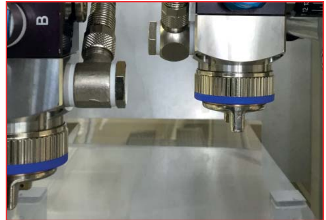
Automatikpistolen zerstäuben das neu entwickelte Material in Schichtstärken von 10 \mu .
